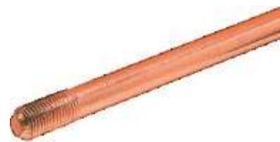
Высококачественная сталь в таком заземлителе выполняет кроме электропроводящей еще и необходимую для зарывания электрода в почву - механическую роль. Штыри обладают высоким пределом прочности на разрыв 600 Н/мм<sup>2</sup> и могут быть погружены в грунт при помощи отбойного молотка на большую глубину (до 40 метров).
