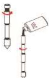
7. Обработать Муфту соединительную Пастой токопроводящей. Закрутить второй Стержень заземления в Муфту соединительную, навернуть следующую Муфту соединительную, обработать Муфту соединительную Пастой токопроводящей, ввернуть Головку удароприемную.
